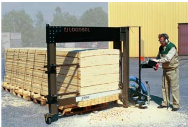
Éboutage avec la scie à paquets Stack Cutter de Logosol
