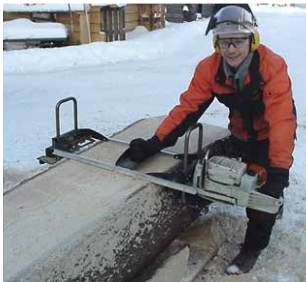
LSG sans rails guides. La surface plate de la grume oriente la prochaine coupe.
