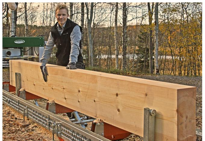
*Das Ergebnis: Ein 4 Meter langer gerader und gehobelter Balken mit den Maßen 20x50 cm). Beeindruckend ! (Die maximalen Maße die gehobelt oder gefräst werden können, liegen bei 60 x 60 cm*
