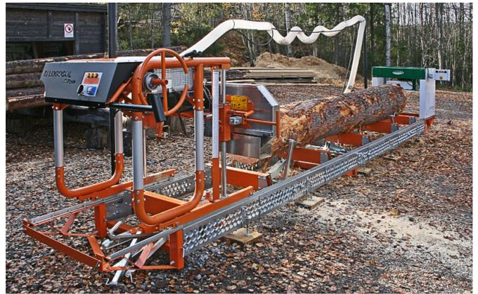
*Korrekte Aufbauweise: Das Sägewerk steht fest auf einem ebenen Grund. Der Absaugschlauch und das Stromkabel sind auf Rollen auf der Leitung (Kabel, Seil, Draht) aufgehängt, die zwischen zwei Pfosten gespannt ist. Der Stamm liegt bereit, fertig zum Sägen und Fräsen. Kabelaufhängung mit Rollen, Kabel-Pfosten, Spanauslass, Absaugschlauch und Spänestützen sind Zubehör, das Sie bei Logosol bestellen können.*
