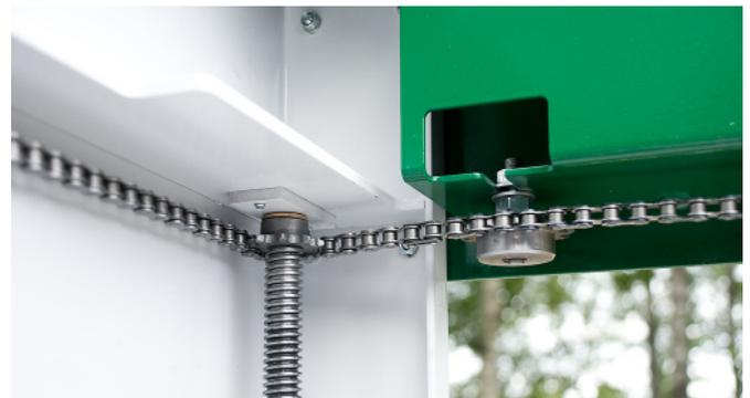
Der Kettenantrieb sollte leichtgängig sein! Auf dem Foto können Sie außerdem den Kettenspanner sehen.
