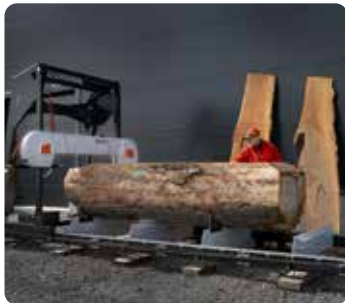
• Sägt Stämme mit bis zu 1651 mm Durchmesser und unbesäumte Dielen (Slabs) mit 1500 mm Breite!
