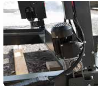
• Stufenloser Vorschub mit 2 synchron gesteuerten Motoren.
