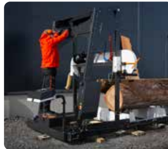
• Werkzeugkasten dient auch als Trittbrett für einen einfacheren Zugang für die Wartung.
