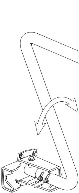
Lösen Sie die Schrauben des unteren Armrohrs.
