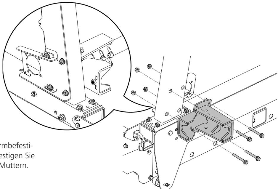
Montieren Sie die Schiebearmbefestigung am Sägerohr und befestigen Sie sie mit vier Schrauben und Muttern.
