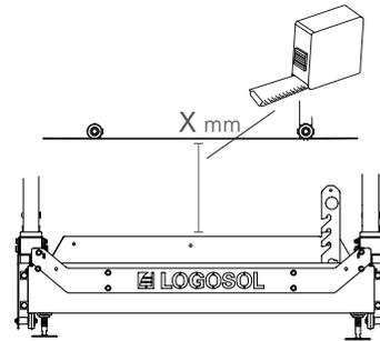
Drücken Sie die Kalibrierungstaste, bis der im Display angezeigte Wert verschwindet, geben Sie dann den gemessenen Wert ein. Beenden Sie den Vorgang, indem Sie die Eingabetaste drücken.
