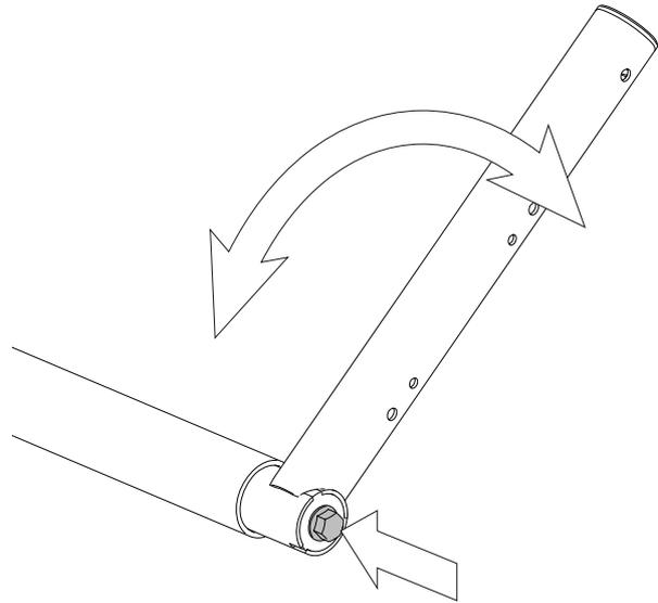
Lösen Sie die Schraube des oberen Armrohrs.
