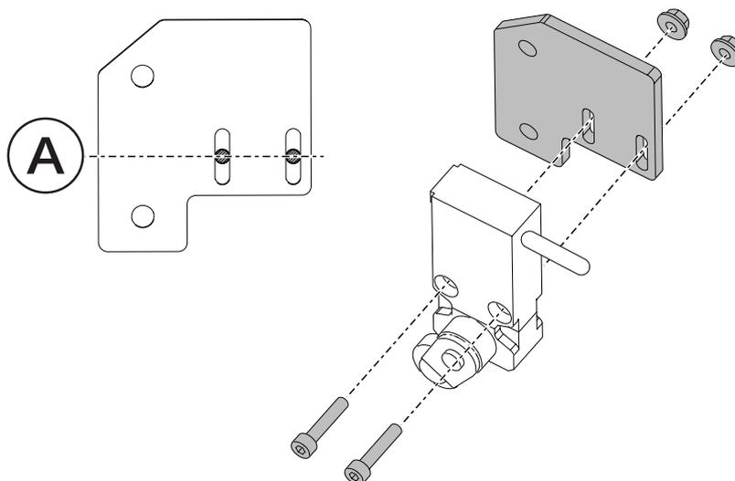
Montieren Sie den oberen Endschalter mit zwei Schrauben und Muttern vor. Zentrieren Sie (A) die Schrauben in den länglichen Löchern der Montageplatte.
