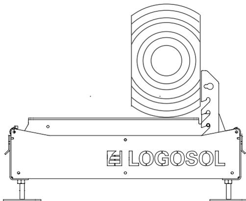
*Drehen Sie den Baumstamm um 90°, so dass eine der frisch gesägten Seiten flach an den Stammanschlagen anliegt und dann festklemmen.*
