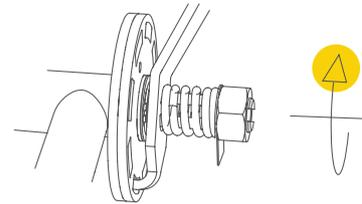
Stellen Sie sicher, dass der Sägekopf leicht abgesenkt werden kann, indem Sie die Kurbel hineindrücken und gegen den Uhrzeigersinn drehen.
