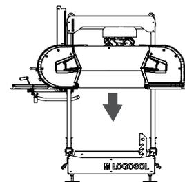
**Tipp:** Arbeite mit dem Sägekopf in der niedrigste Position abgesenkt, um den Zugang zum Motor zu erleichtern.
