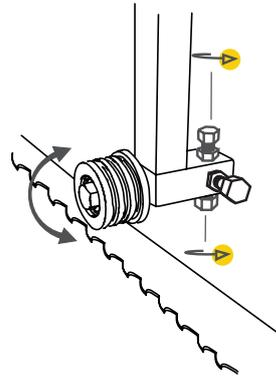
Die Bandführungen müssen so eingestellt werden, dass sie parallel zum Bandrücken stehen. Dies geschieht durch das Verstellen der äußeren und inneren Einstellschrauben. Es ist entscheidend, dass die Bandführungen parallel zum Band verlaufen. Achte darauf, diese richtig einzustellen.
