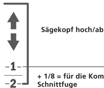
Auf der Kurbelwelle gibt es eine Öffnung, wo Sie Zahlen auf einer Skala sehen können. Diese Skala hat acht Schritte, wobei jeder Schritt 1/8 Zoll ist. **TIPP:** Wenn ein Brett oberhalb des Bandes geschnitten wird, müssen Sie für die Schnittfuge, d.h. 1/8", kompensieren. Das Schnittholz unter dem Band muss nie für die Schnittfuge kompensiert werden. Es hat das gleiche Maß, das auf der absoluten Skala auf dem vorderen Bein des Sägekopfes gezeigt wird.
