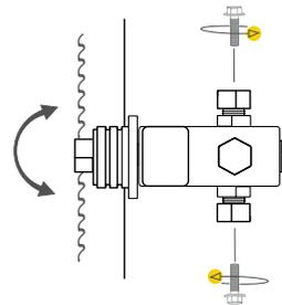
Die Bandführungen können nach dem Lösen der Einstellschrauben durch Ziehen oder Drücken der Achse nach innen und außen eingestellt werden. Das Band sollte mit der Rückseite ca. 3-5 mm von der Hinterkante der Bandführungsrolle aufliegen.
