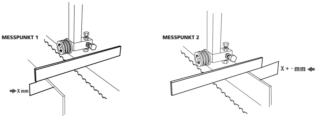
Wenn sich die Messungen unterscheiden, drehe die Einstellschrauben an der Bandführung, bis die Messungen an beiden Messpunkten übereinstimmen. Eine Methode, um die Einstellung zu erleichtern, besteht darin, den Wert von Messpunkt 1 zu verwenden, ihn mit dem Wert von Messung 2 zu vergleichen und dann die Hälfte der Differenz durch Anheben oder Absenken der Blattführung an Messpunkt 2. Wenn das Band parallel ist, wiederhole die Einstellschritte an der anderen Bandführung.
