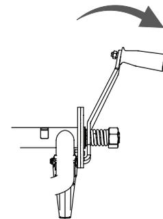
Sobald der Griff gut eingestellt ist, biegen Sie die Sicherungsscheibe, um die Sicherungsmutter in Position zu halten.
