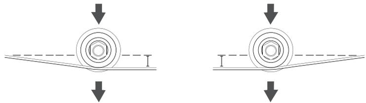
Mit den Bandführungen können die Winkel des Bandes, gemessen in der Richtung des Schnitts, durch Einstellen mit der oberen und unteren Einstellschrauben eingestellt werden.
