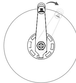
Der Verriegelungsmechanismus der Kurbel ist in acht Schritte pro Umdrehung unterteilt. Bei jedem Schritt wird der Sägekopf um 1/8 Zoll und bei einer vollen Umdrehung um 1 Zoll gesenkt bzw. erhöht.
