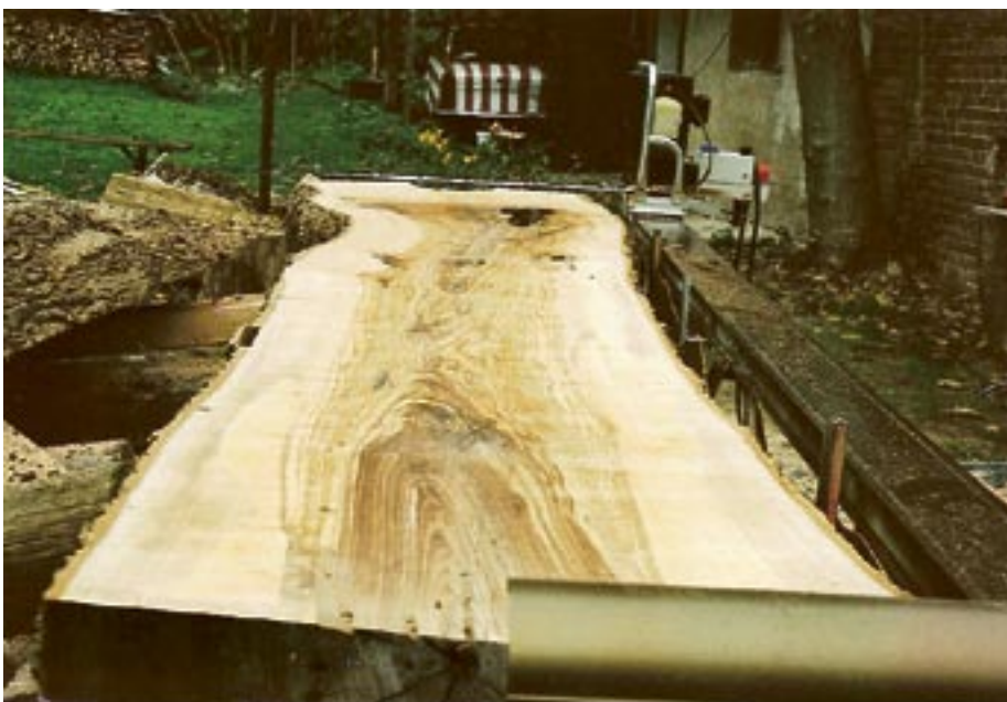
Der Aufsatz E6000 hat jeden Schnitt der harten Esche mit der längsten Kettenschiene durchgezogen. Das Logosol hat diesen harten Test ohne Probleme oder Schäden bestanden. Bei noch dickeren Stämmen würde der erste Schnitt unterhalb des Kerns erfolgen.
