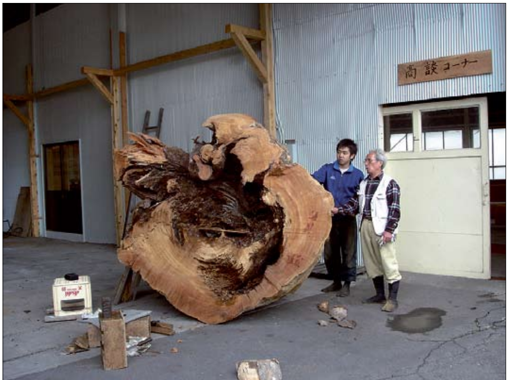
Sie gehören zu den letzten ihres Berufs: Hayashi Lichi und sein Lehrling Higashide Chōyō produzieren hochwertiges Bauholz von Hand. Die genaue Begutachtung eines Stammes oder einer Maserknolle mit der Schnittplanung dauert Stunden.
