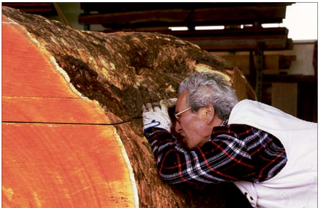
Hayashi kontrolliert immer wieder den korrekten Verlauf des Sägeschnitts.
