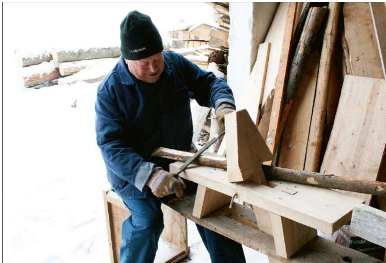
Heinrich Schmidberger an seiner Schnitzbank, die schon sein Großvater im Gebrauch gehabt hat. Die geniale Konstruktion von damals ist auch heute noch schneller und besser als das Hantieren mit dem Schraubstock. Ein Stück Holz wird mit dem Fuß eingespannt und kann jetzt leicht mit dem Zugeisen abgezogen werden. Lediglich die Spannbacken musste Schmidberger mit Hilfe seiner M7 erneuern.
