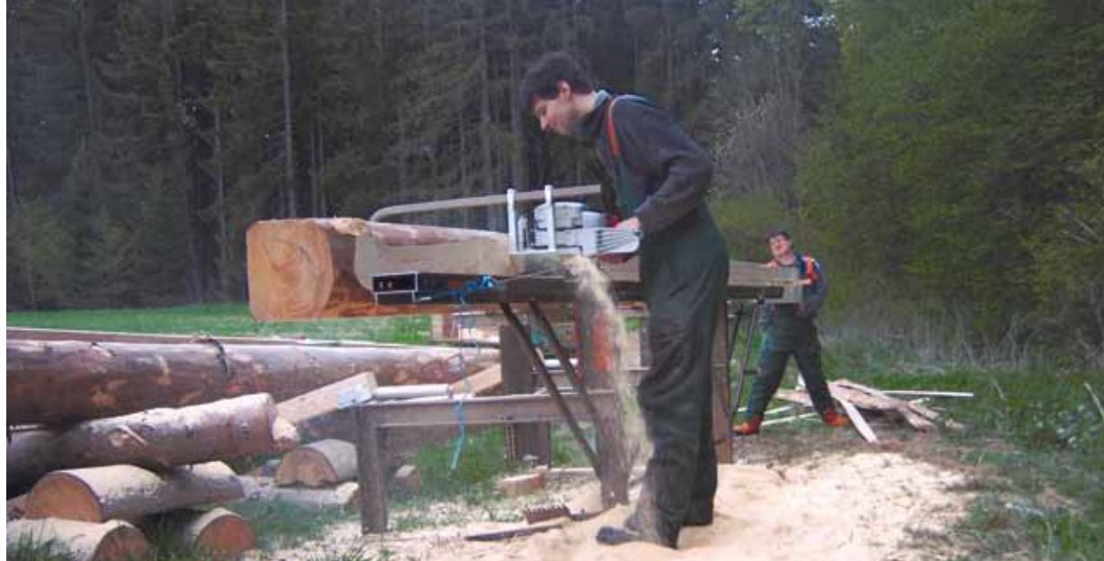
Norbert Werner (vorne) und sein Schwager Matthias an der M7. Sie konnten die Stämme durch überlegtes Wenden und stückweises Sägen auch ohne zusätzliche Verlängerung aufschneiden und das Holz so einteilen, dass Holzfehler wegfielen.
