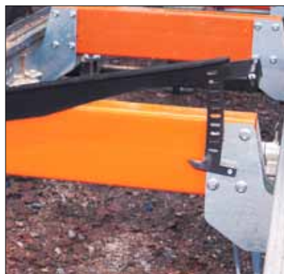
Der neue Stammheber für die LM40. Ein gutes Hilfsmittel, um die Stämme auf dem Sägewerk zu positionieren und zu drehen.
