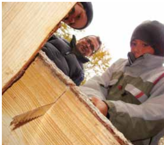
Aufgabe der Kinder ist nun, die vorgezeichneten Kerben an der Sitz- und Lehne-Bohle auszusägen.
