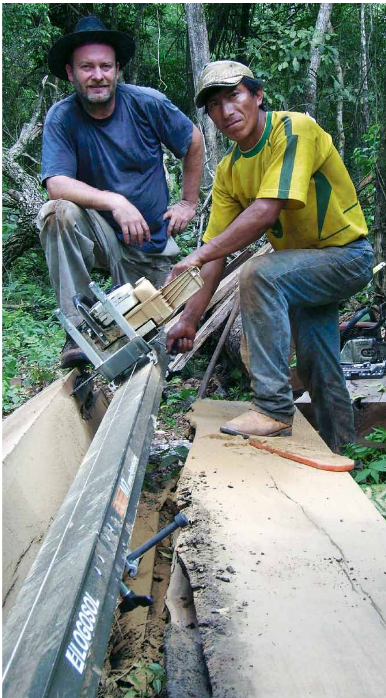
Mit Hilfe des M7 sägt Johannes Kunzi von der Mission Alemana DIPM zusammen mit einem Indigena das Dachgebälk für das Haus der Cooperativa (Genossenschaft).
