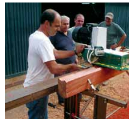
Erster Arbeitsschritt für die Kursteilnehmer: Die Blöcke werden auf dem M 7 mit dem Blockhausfräsenaufsatz gefräst.
