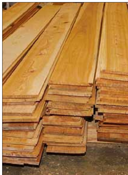
30 Zentimeter breite Zypressenbretter werden durch den Hobel gejagt.
