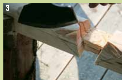
3 Hier wird der Schalm mit dem Beil behauen.
