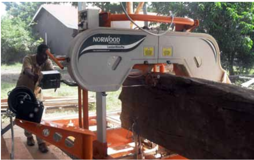
• Nach intensiver Einarbeitungszeit am LMPro können die Schreiner der Handwerkerschule jetzt ganze Stämme ohne Holzverlust schneiden.
