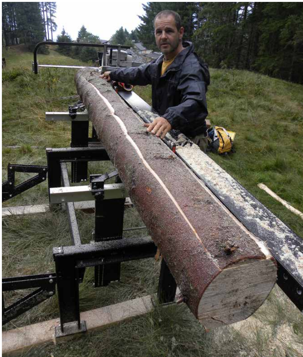
• In den Tessiner Alpen ist es für Matthias Bachofen dank seines Logosol M8 manchmal einfacher, einen Stamm vor Ort aufzuschneiden.
