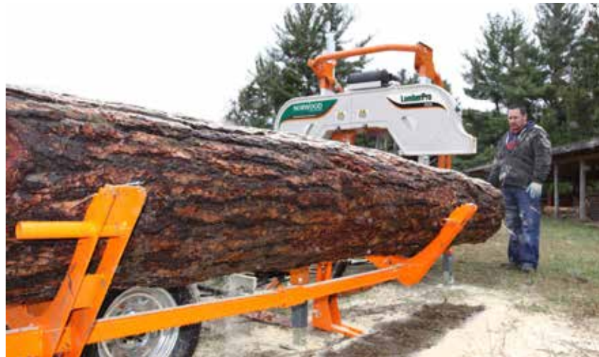
• Robuste Technik für harte Arbeit. Das neue Bandsägewerkmodell: LumberPro HD36 schafft sehr große Stämme ohne Probleme. Die Obergrenze für den Stammdurchmesser beträgt jetzt ganze 90 Zentimeter.
