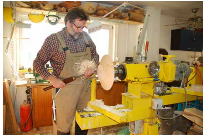
• Andreas Frühlingsdorf bei der Arbeit an der Drechselmaschine, die er als gelernter Werkzeugmachermeister selbst konstruiert hat.
