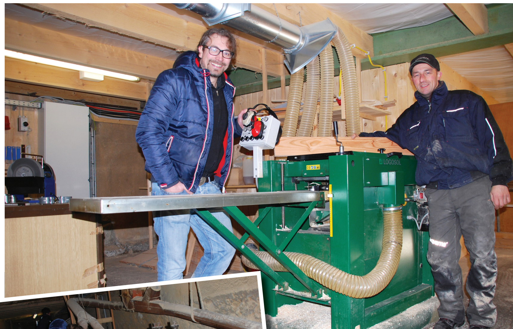
• Klein, fein und flexibel: Der Logosol PH260 mit vier Messerwellen und stufenlosem Vorschub hobelt und profiliert alle vier Seiten eines Werkstückes in einem Arbeitsgang. Das macht ihn für den Sägewerksbetrieb von Alex Kieferle geeignet, der hohe Anforderungen an das Hobelergebnis, Flexibilität und Tempo stellt.
