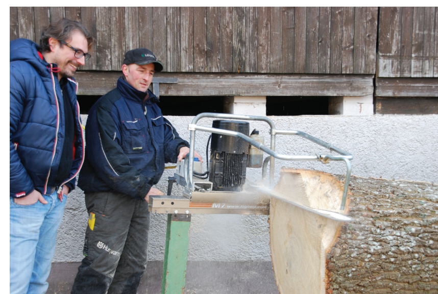
Alex Kieferle demonstriert auf beeindruckende Weise, wie er mit dem Holmsägewerk Marke Eigenbau große Stämme schnell und effektiv auf ein geeignetes Maß für die Gattersäge schneidet.
