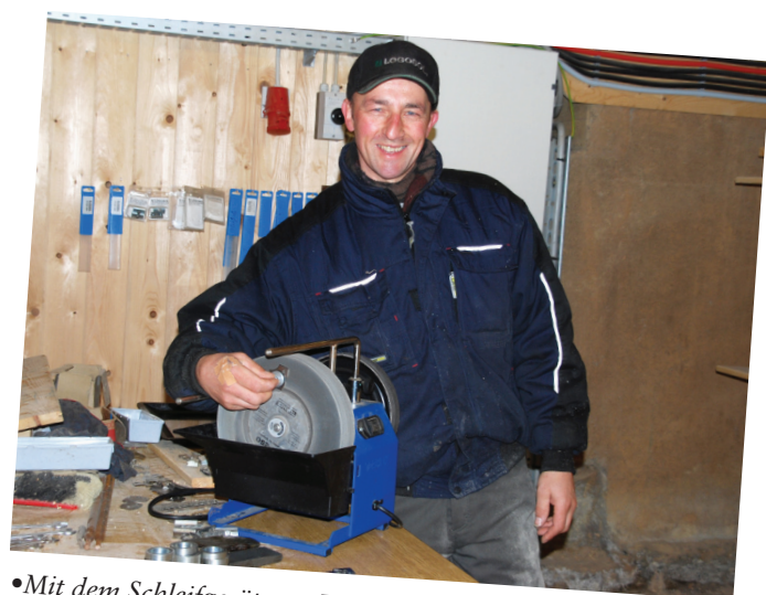
• Mit dem Schleifgerät von Logosol werden die Hobel- und Profilmesser schnell wieder einsatzbereit.
