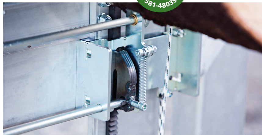
• Robuste Konstruktion. Eine stabile Klinke rastet für die Schnittstärkeneinstellung in die Zahnstange ein. Die Klinke schließt alle 1/4 Zoll. (6,1mm)
