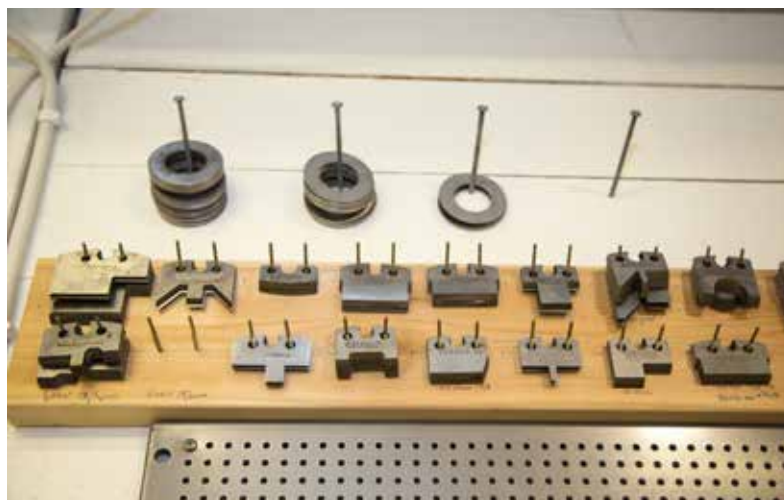
• In der Produktion werden Standard-Profilmesser und Sondermesser verwendet.
