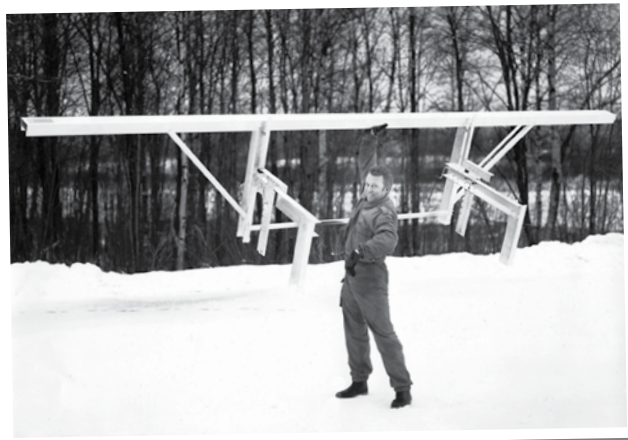
• Bengt-Olov Byström hebt im Jahr 1989 das erste Sägewerksmodell mit einem Arm. Es wog 37 Kilogramm ohne Motorsäge.
