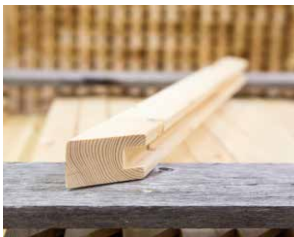
• Fertig gehobelte Fensterbögen warten auf die Glasmontage.
