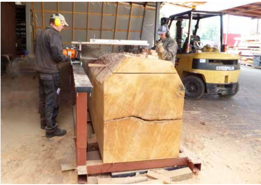
• Mit einer zehn Meter langen Spezial-Schiene von Logosol kann der Eichenstamm in Achteckform Stück für Stück geschnitten werden.
