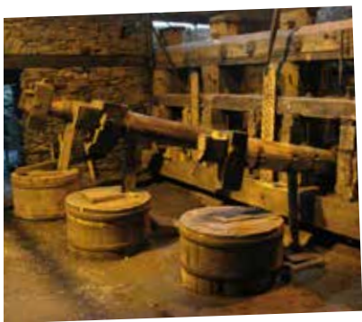
• Die neue acht Tonnen schwere Welle treibt die drei historischen Schwanzhämmer an, die eine Schlagkraft von rund zwölf Tonnen entwickeln.
