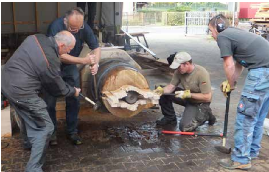
• Für die Funktionalität der neuen Welle im Hammerwerk wird ein Eisenzapfen eingelassen und mit Manschettenringen fixiert.
