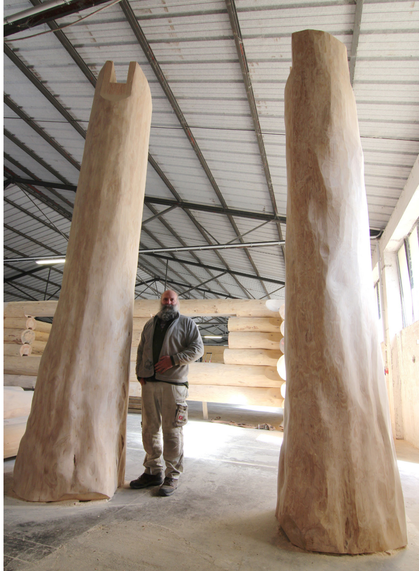
• Bruce in seiner Fertigungshalle, in der Wände aus ganzen Stämmen in Handarbeit vorgefertigt werden.
