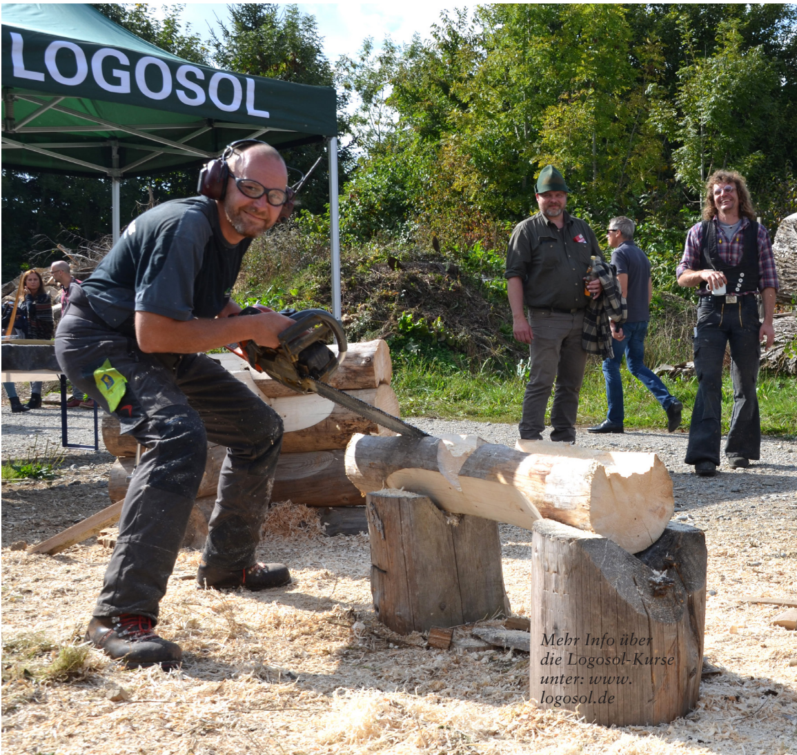
• Logosol-Kursleiter Sven Gerstenecker präsentierte live den Blockhausbau in Rundholzbauweise.
