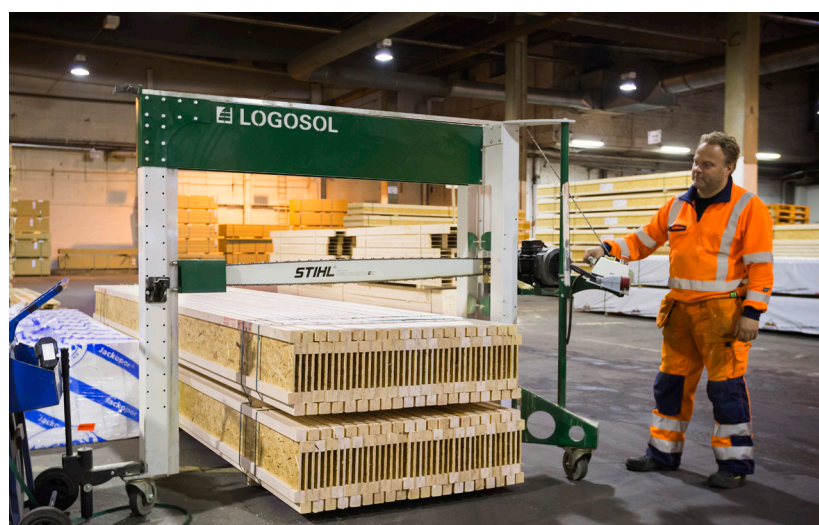
• „Einfach und bedienerfreundlich“, sagt der Operator Erik Högländer über die Paketkappsäge, die für das exakte Ablängen der Stegträger für die Hausherstellung konzipiert wurde. „Die Paketkappsägen erfüllen unsere hohen Anforderungen an Genauigkeit und Kapazität.“
