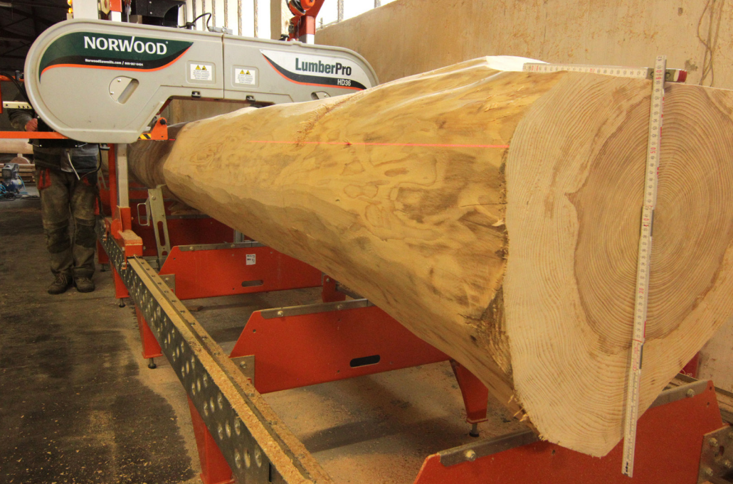
• Das große Bandsägewerk LMPPro HD36 von Logosol, das auf 18 Meter Länge erweitert wurde, dient dem präzisen Abrichten der Stämme.
