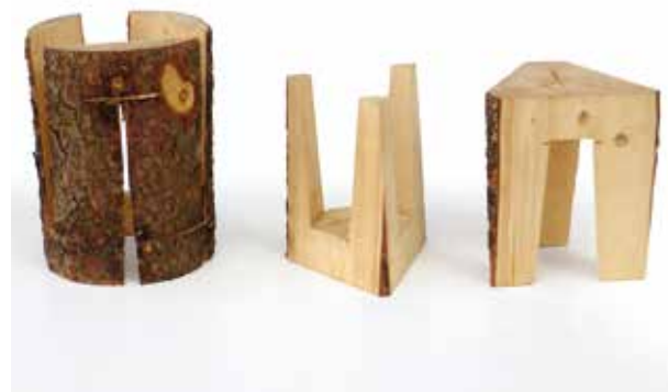
• Optimale Ausbeute aus einem Fichtenstamm: zwei gleiche Sitz-Hocker, ein erster Prototyp für die Produktion einer Kleinserie.
