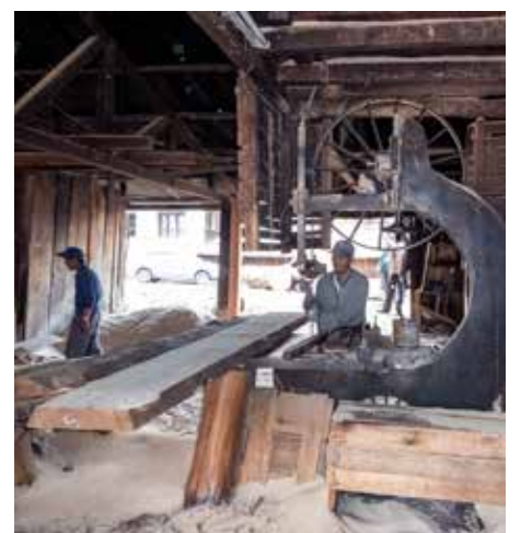
• Logosol besuchte auch ein lokales Sägewerk in Bhutan, welches große Stämme mit einer gigantischen Bandsäge schneidet. Das Bild rechts zeigt eine Trennsäge für das Besäumen von Dielen frei Hand. „Ein nicht ausreichender Arbeitsschutz aus europäischer Sicht“, kommentierte Bengt-Olov.
