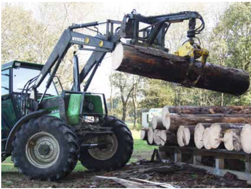
• Ein Traktor mit Holzgreifer legt die Stämme der Weymouth-Kiefer auf dem Logosol-Bandsägewerk SH 29 in Position.
