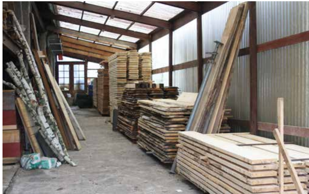
• In seinem Holzlager stapelt Michael über den Sommer die Bretter der Weymouth-Kiefer, die er im Frühjahr mit seinem bandsägewerk schneidet.
