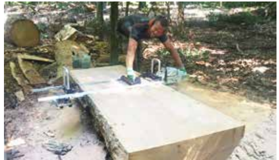
• Simon Fischbach sägt mit seinem Big Mill mit je zwei Führungsholmen und Motorsägen einen dicken Eichenstamm vor Ort im Wald.
