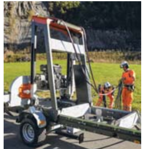
• Das fachmännische Anbringen der Tragegurte erfolgt mit einer mittigen Schlaufe, damit das Bandsägewerk nicht in der Luft rotiert.
