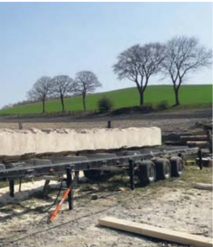
• Für das Sägen in hohen Dimensionen: Am Bandsägewerk B1001 wurde das Sägebett auf 9,50 Meter verlängert und mit Trailer-Kit auch mobil.
