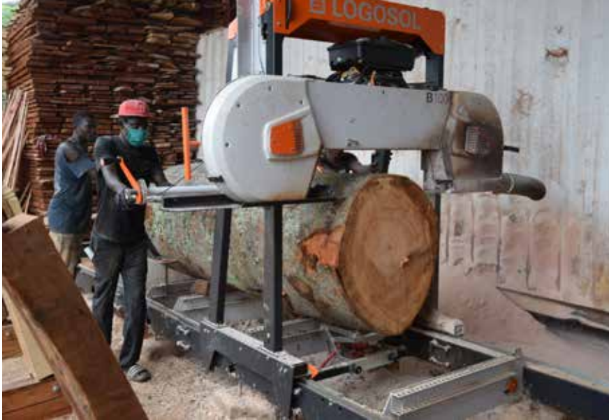
• Vom Stamm über das Band 1001 bis zum maßhaltigen Holz, das auch zur Vermarktung und Finanzierung der Schule geschnitten wird.
