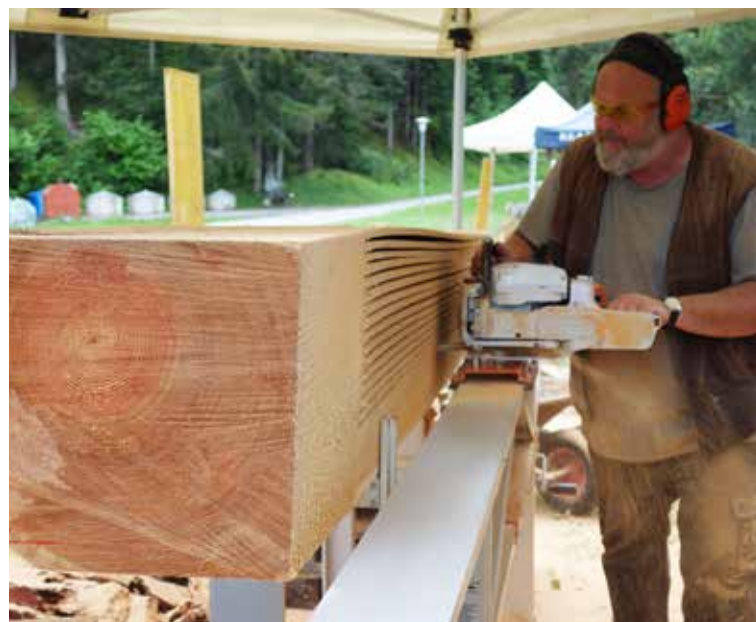
• Die Anzahl und der Rhythmus der Einschnitte und Spreizkeile bestimmen das jeweilige Design – von schlicht bis komplex.
