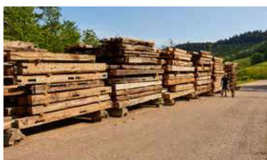
• Auch historisches Holz wird als Werkholz in größerer Dimension beispielsweise mit der Gattersäge geschnitten und auf dem Werksgelände gelagert.
