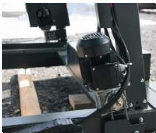
• Stufenloser Vorschub mit 2 synchron gesteuerten Motoren.
