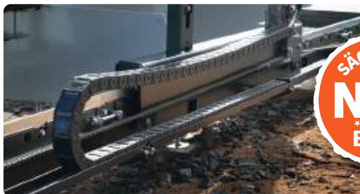
• Integrierte Kabelhantierung mit Energiekette. Sägewerk wird stillstehend am Pult bedient.
