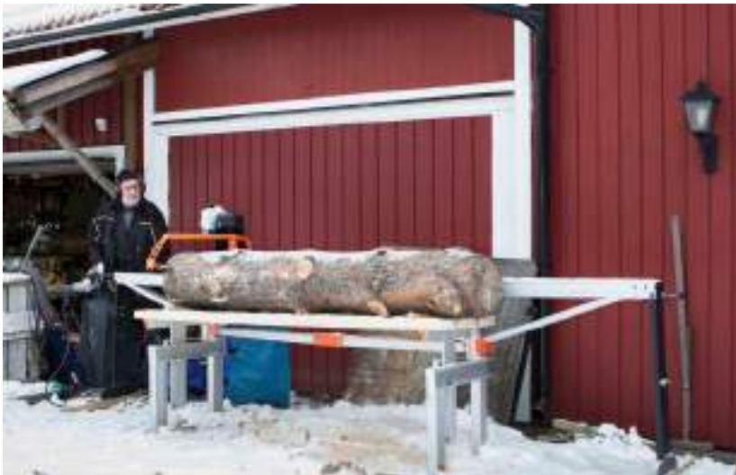
• Ove steckt das Kabel ein, setzt den Gehörschutz auf und schaltet die Säge ein. Ein großer Kiefernholzstamm wartet auf dem Sägwerk."
