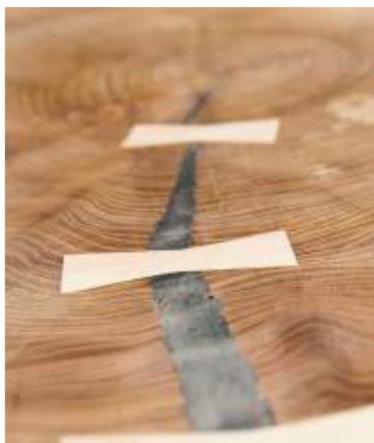
• Um Risse zu stabilisieren, wählt Alexander eine dekorative Verbindungstechnik, bei der er ein Verriegelungsstück in Form einer Schleife oder einer Rose einsetzt, das präzise passt und die Bretter zusammenhält.
