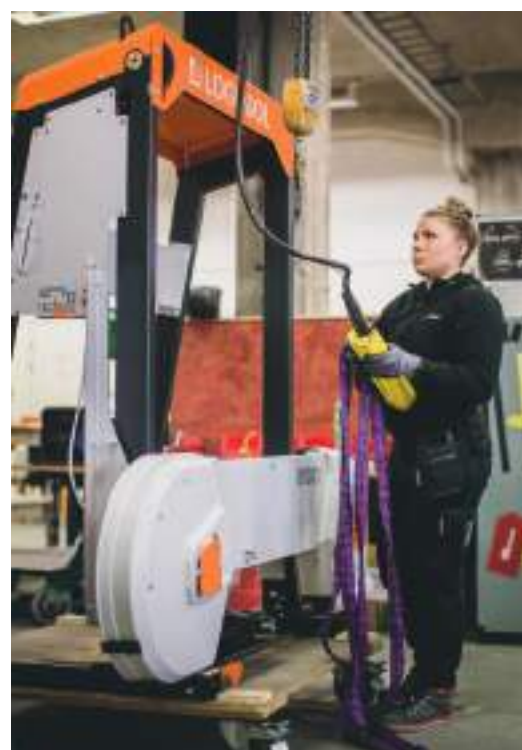
• Linda Östman hebt einen Bandsägenkopf aus der Produktionslinie Schritt 2 für den Weitertransport zu Schritt 3.
