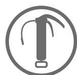
Lorsque ce symbole apparaît pendant le travail d'assemblage, les pièces doivent être lubrifiées avant l'assemblage. Lubrifiez les pièces concernées avec de la graisse universelle.
