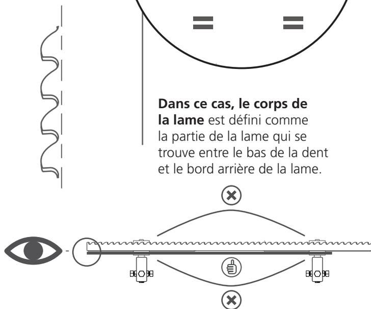
Si la lame se gauchit dans le sens de la scie, la lame est positionnée trop en avant sur les roues. Si le gauchissement se fait dans l'autre sens, le positionnement est trop en arrière.
