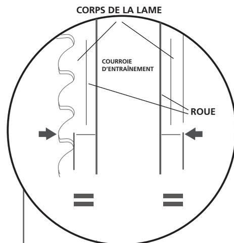
**Dans ce cas, le corps de la lame est défini comme la partie de la lame qui se trouve entre le bas de la dent et le bord arrière de la lame.**
