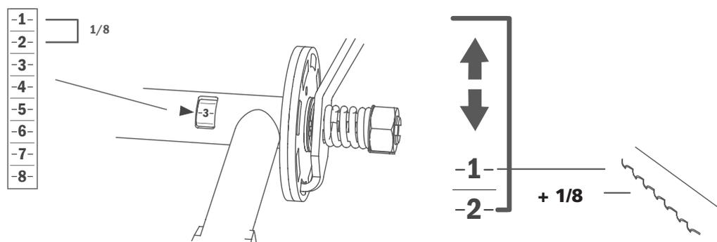
Sur le vilebrequin, il y a une ouverture dans laquelle vous pouvez voir une numérotation. Elle est numérotée en 8 pas où chaque pas mesure 1/8e de pouce. **ASTUCES** : Lorsqu'une planche est sciée sur le dessus de la lame, compensez toujours l'épaisseur de la lame, c'est-à-dire 1/8". Le morceau de bois qui se trouve sur la face inférieure de la lame n'a jamais besoin d'être compensé. Il a la dimension qui est marquée sur l'échelle graduée de hauteur absolue.
