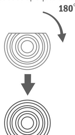
*Faites pivoter la grume sur 180° pour que la partie qui vient d'être sciée soit plaquée contre la table à grume.*
