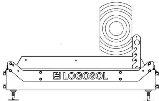
*Faites pivoter la grume de 90° de manière à faire reposer l'une des faces sciées sur le support de grume, puis serrez la grume.*
