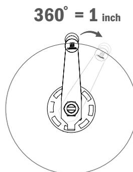
Le mécanisme de verrouillage de manivelle est subdivisé en huit positions sur une rotation. Chaque position correspond à un déplacement de 1/8e de pouce de la tête de scie et un tour complet équivaut à 1 pouce. Le disque subdivisé en 16 étapes est disponible en tant qu'accessoire.
