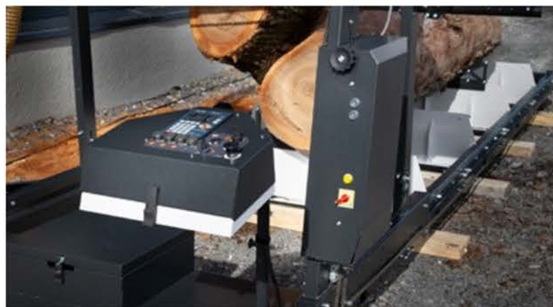
Pupitre du ProSet permettant l'enregistrement des coupes et la commande de la scierie.
