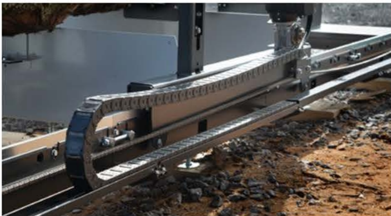
Le câblage est protégé par une chaîne porte-câbles, conçue pour prévenir l'usure et accompagner les connectiques dans tous les mouvements de la scie.
