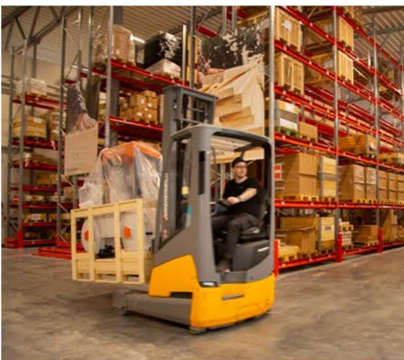
Simon file à travers l'entrepôt avec le gerbeur, capable de gérer les rayonnages extra-hauts.
