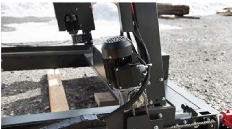
Un des deux moteurs du ProFeed permettant l'avancement de la tête de coupe.
