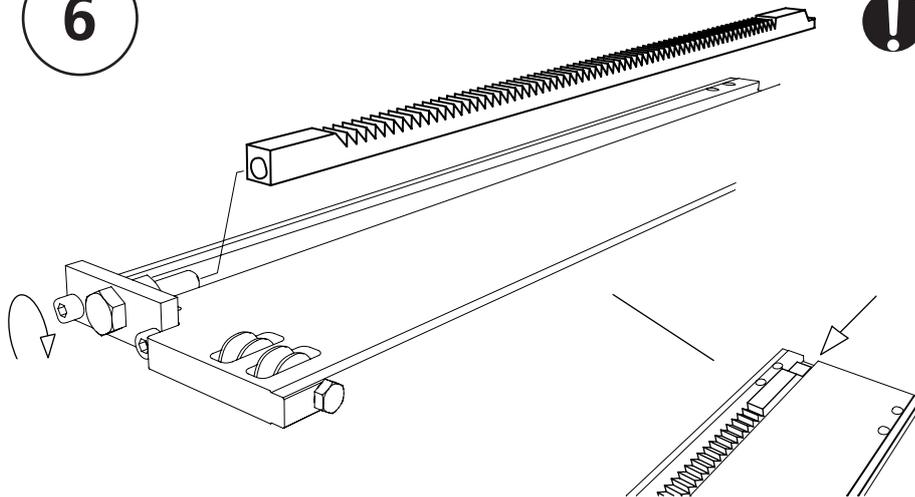
**!** Assurez-vous que l'extrémité de la barre à cliquet ne dépasse pas l'extrémité de la poutre de levage, cela rendrait impossible l'assemblage de la table à grumes. La barre à cliquet est généralement légèrement pliée vers le côté cranté. Lorsque vous allez la visser, la tension créée va la serrer contre la poutre de levage.
