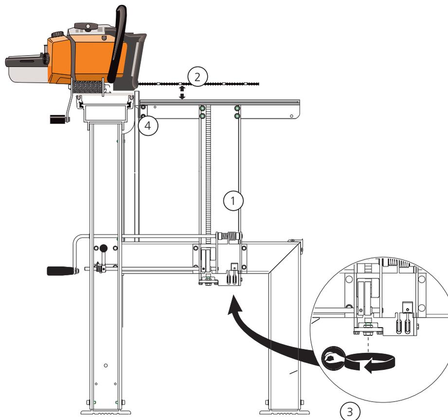
**1** Vérifiez que lorsque la table à grumes est abaissée, elle se déplace facilement à travers le boîtier de la came à cliquet sous l'effet de son propre poids. Si tel n'est pas le cas :
