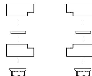
**!** Les glissières doivent être assemblées comme indiqué sur l'illustration B, lorsque le chariot porte-scie est équipé d'une manivelle et d'une barre d'extrémité de guide.
