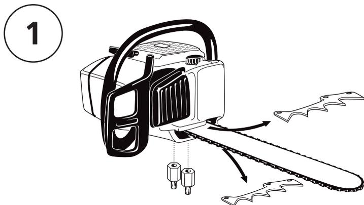
Dévissez les deux écrous du guide-chaîne de la tronçonneuse et retirez le capot du guide-chaîne.
