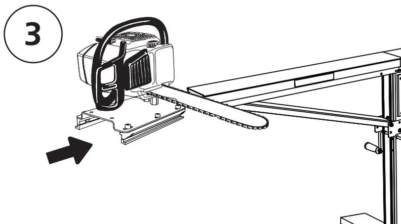
Poussez le chariot sur le rail de guidage avec le guide-chaîne orienté vers les tables à grumes.
