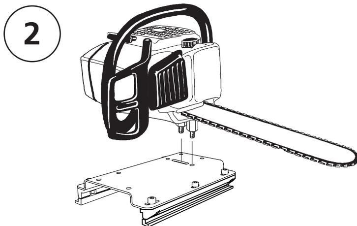
Montez les écrous Logosol dans la rainure sur le chariot. Fixez la tronçonneuse en place à l'aide des écrous du guide-chaîne de la tronçonneuse se trouvant sous la plaque.
