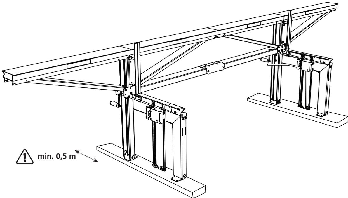
Lorsque la scierie est placée à même le sol, la surface doit être suffisamment ferme et de niveau pour y faire rouler une voiture.
