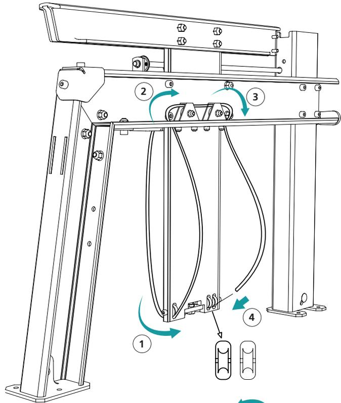
De l'autre côté, faites passer le câble via la poulie pour corde dans le logement de la came à cliquet, puis à travers la poutre de levage.
