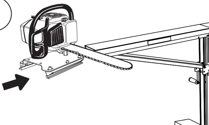
Poussez le chariot sur le rail de guidage avec le guide-chaîne orienté vers les tables à grumes.
