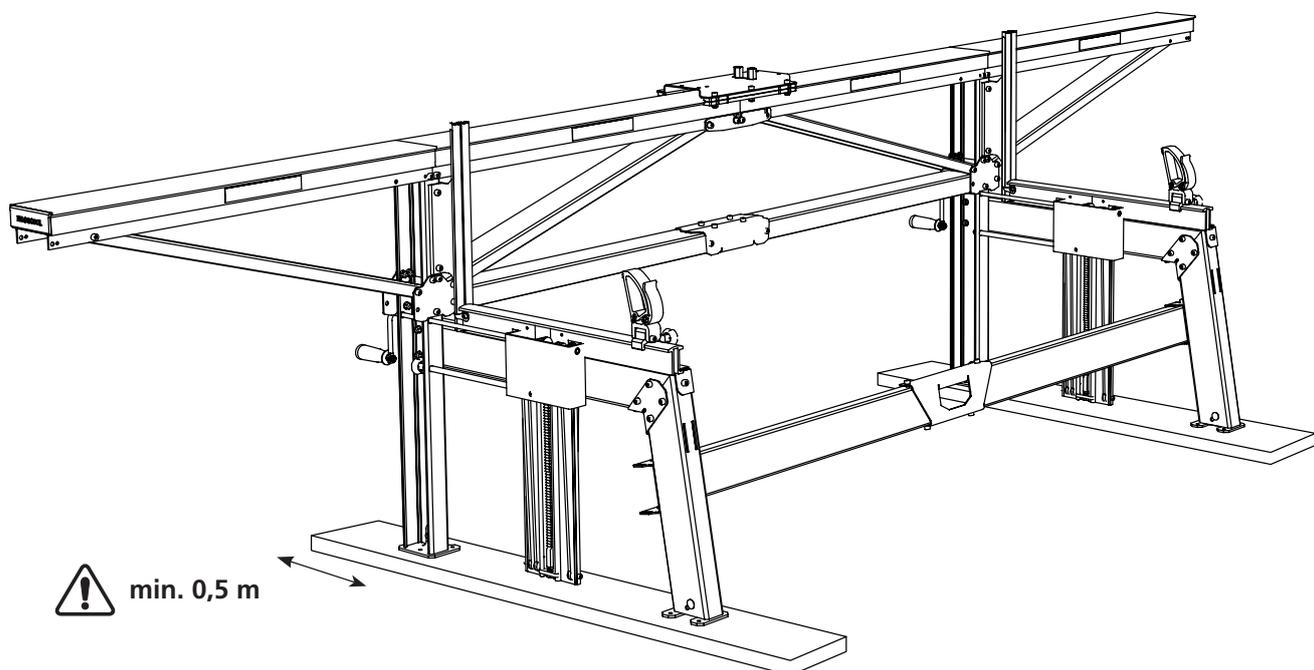
Lorsque la scierie est placée à même le sol, la surface doit être suffisamment ferme et de niveau pour y faire rouler une voiture.
