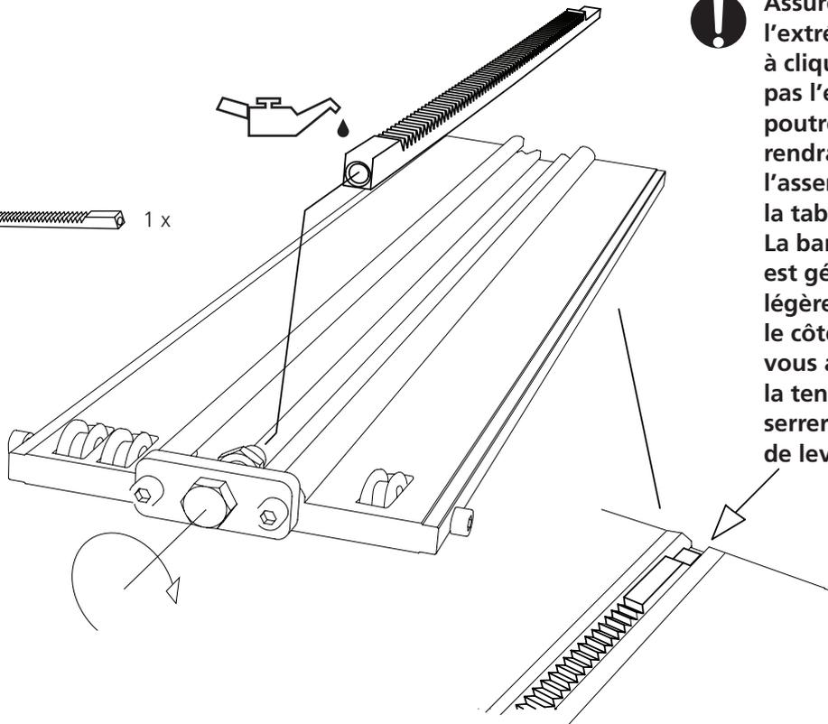
**!** Assurez-vous que l'extrémité de la barre à cliquet ne dépasse pas l'extrémité de la poutre de levage, cela rendrait impossible l'assemblage de la table à grumes. La barre à cliquet est généralement légèrement pliée vers le côté cranté. Lorsque vous allez la visser, la tension créée va la serrer contre la poutre de levage.
