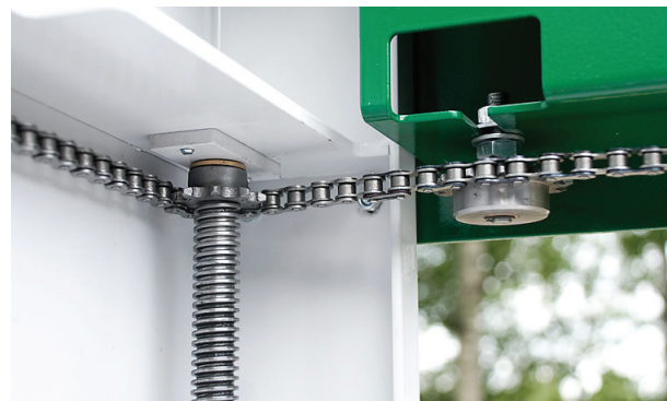
Kjedeoverføringen skal gå lett! På bildet vises også kjedestammeren.
