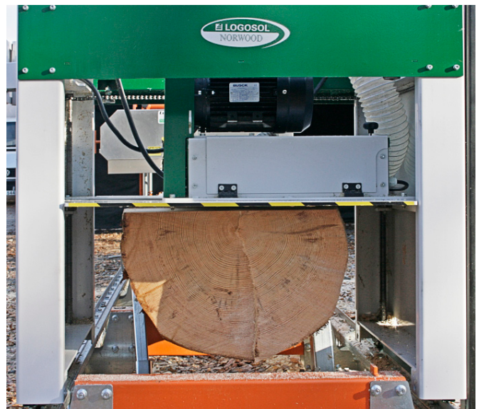
Bearbeitung in zwei Schritten. Hier wurde aus einem 55 cm dicken Stamm eine extreme stabile gehobelte Bank gebaut.
