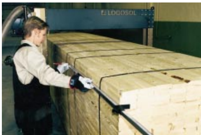
Установите нужную длину на шесте измерителе. Приставьте шест измеритель к верхней и нижней стороне пакета с пиломатериалом (с обеих сторон), сделайте отметки
