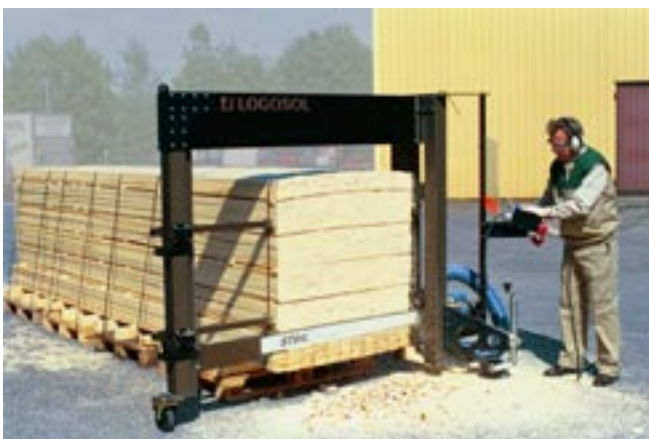
Obcinanie końców za pomocą obrzynarki Paketkap
