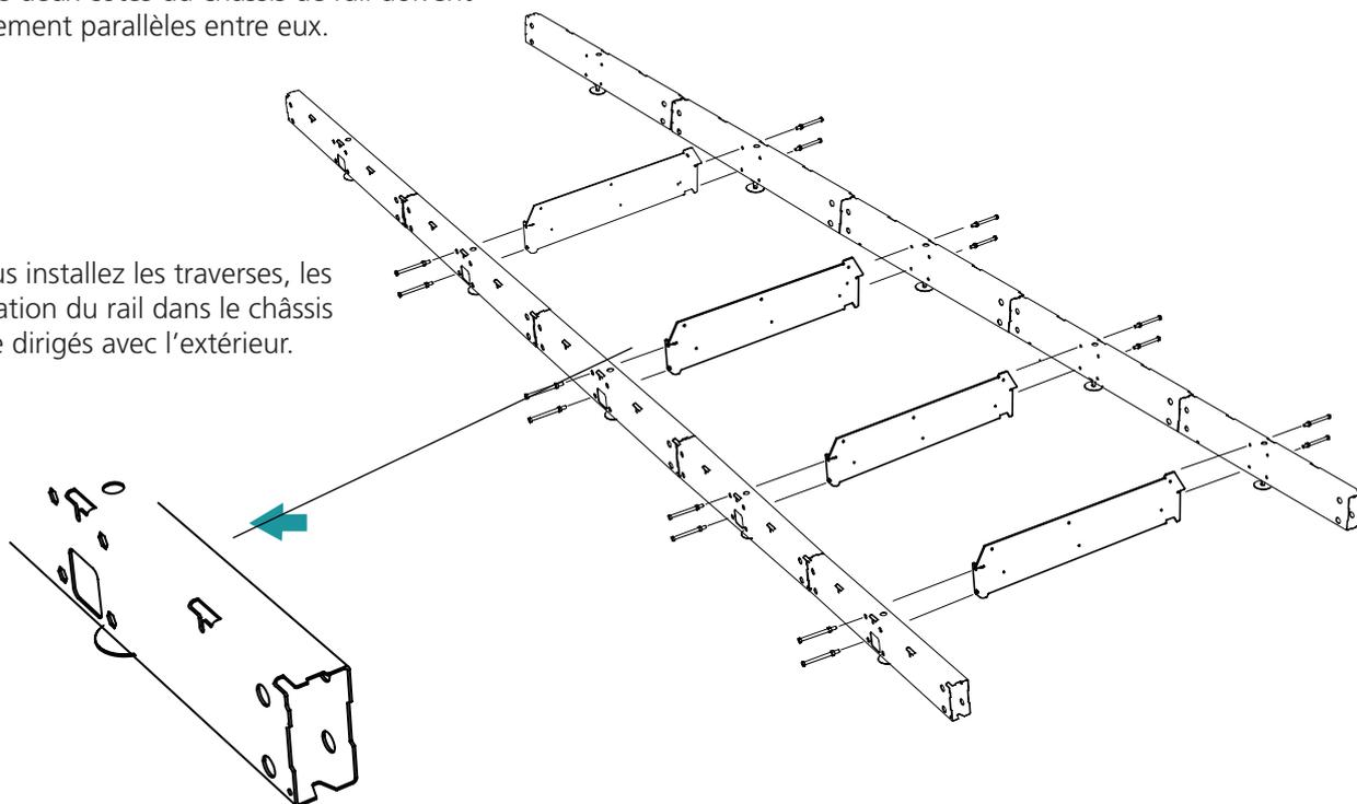
Préparez les raccords boulonnés pour l'installation des traverses dans le châssis de rail. L'écrou doit être serré jusqu'à ce qu'il y ait 20 mm de filetage libre.
