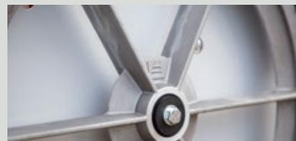
Las ruedas de cinta tienen aspas de ventilador que enfrían la cinta de sierra y expulsan las virutas, con lo que se mantienen el orden y la limpieza bajo la cubierta.
