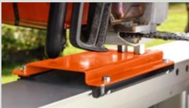
La unidad de sierra se monta fácilmente sobre caballetes que se deslizan con facilidad y precisión sobre el riel guía.
