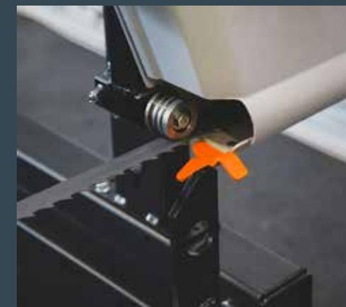
Ein neues praktisches Zubehör, das beim Sägen ausgeklappt werden kann, damit nicht in die Anschläge gesägt wird. **Passend für alle Bandsägen von Logosol.**
