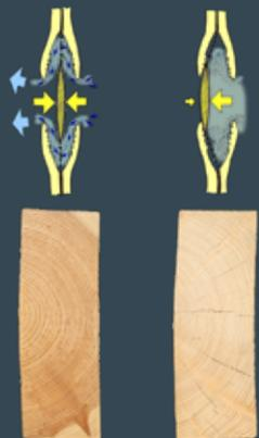
Das Prinzip; die Feuchte im Holzinernen soll die Oberfläche des Holzes feucht halten. Somit ziehen Sie die Feuchtigkeit aus dem Holz raus bevor das Holz auf Grund der Trocknung anfängt zu schrumpfen. Das Holz soll von Innen trocknen.
