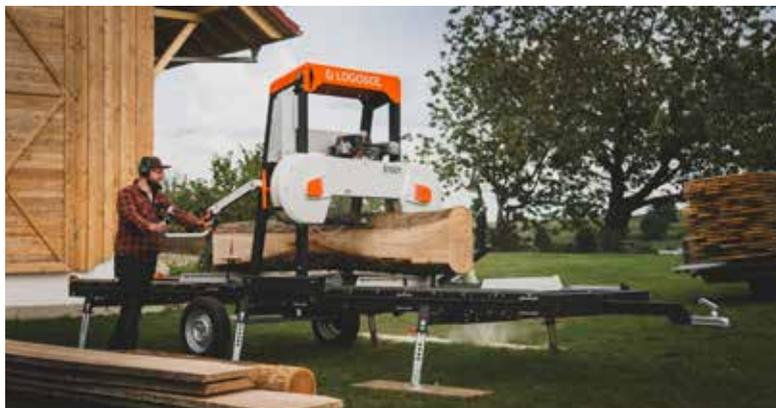
Mach Dein Sägewerk mobil. Geeignet für das B1001 und B751 Pro. 3 Paar Höhenverstellbaren Stützbeinen mit Querverstrebungen. Achse: Ungebremst bis 750 kg. Abnehmbare Kotflügel und Sägekopfarretierung,
