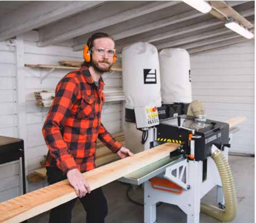
Für optimale Hobelergebnisse empfehlen wir, dass Du vor dem Profilieren die Bretter dimensionierst um die richtigen Maße (Breite und Stärke) zu erhalten. Dies dauert für 100 Laufmeter Holz nur etwa 15 Minuten und ist gut angelegt. Die Planmesser bleiben immer in der Welle.
