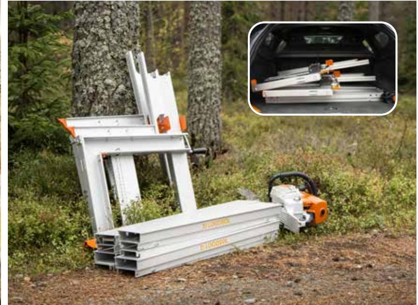
Der Führungsholm besteht aus 1-Meter-Abschnitten, die in den Kofferraum eines Standardfahrzeugs passen. In ein paar Minuten ist das Sägewerk zu Hause, im Garten oder draußen im Wald montiert und aufgebaut.
