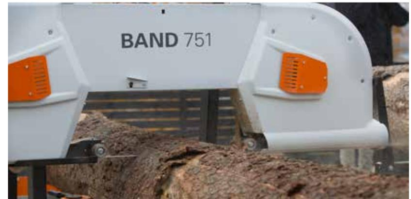
Patentierte Stammhaltung. Eine Stammklemme und zwei Stammanschlüge sind im Lieferumfang enthalten. Sie fixieren den Stamm mit großer Kraft, ohne Spuren im Holz zu hinterlassen. Sie sichern das Holz vom ersten bis zum letzten dünnen Brett.
