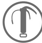
Lorsque ce symbole apparaît pendant le travail d'assemblage, les pièces doivent être lubrifiées avant l'assemblage. Lubrifiez les pièces concernées avec de la graisse universelle.
