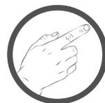
Serrez l'assemblage à vis à la force des doigts.
