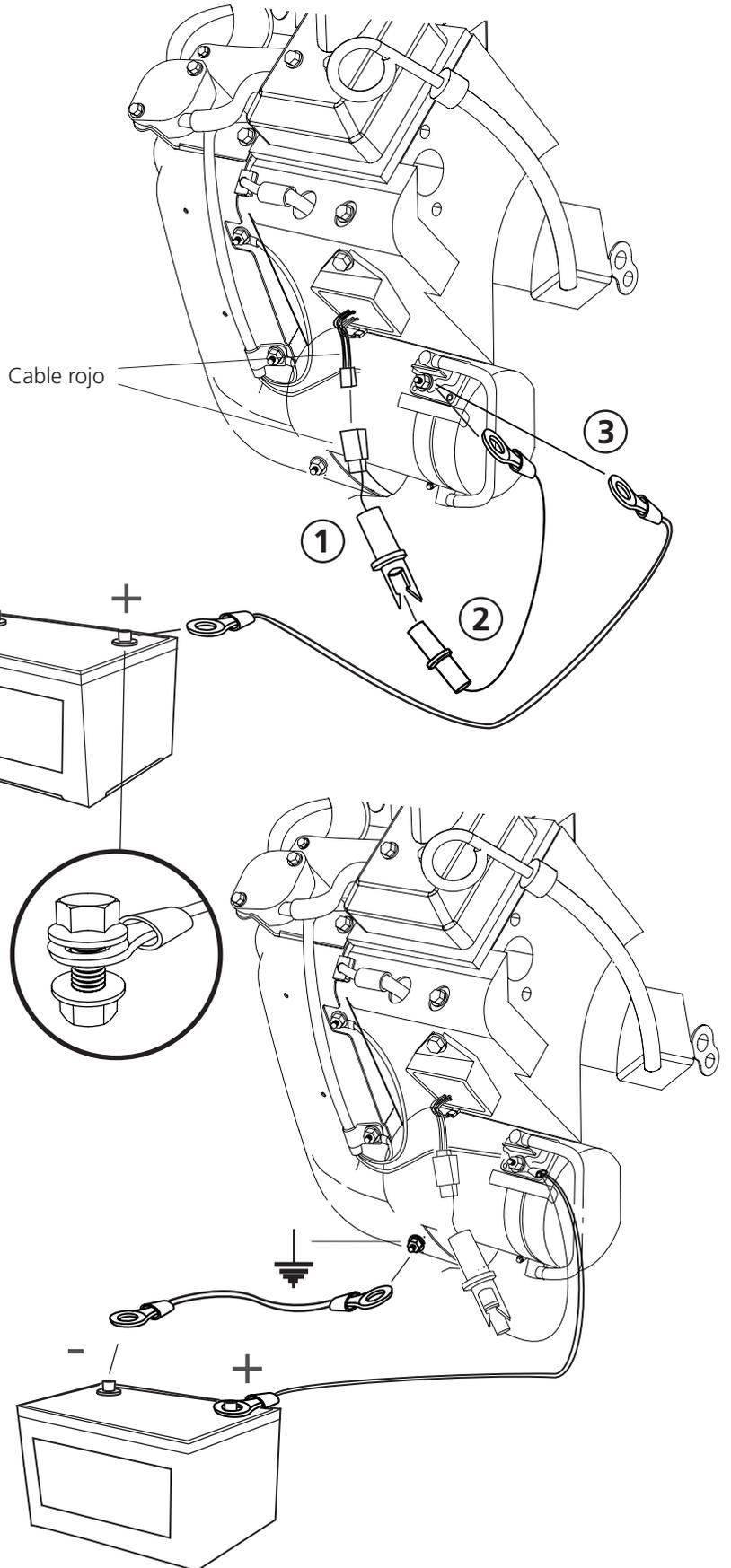
Ahora conecte el cable de tierra al punto de tierra del motor. El otro extremo debe conectarse al terminal negativo de la batería.
