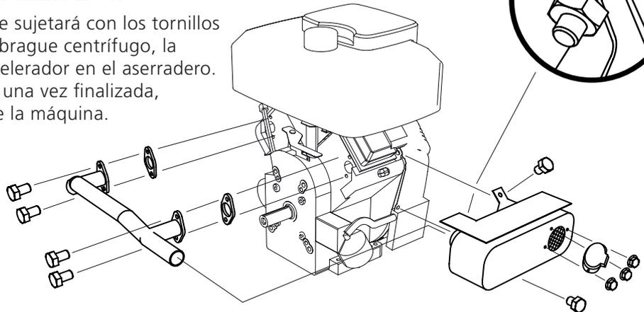
**2** Monte el motor en el soporte del motor: Monte el motor en el cabezal de la sierra antes de colocar este último en los rieles. A la hora de levantar el motor para colocarlo en su sitio, debe haber dos personas. La siguiente ilustración muestra el diagrama de orificios para montar el Briggs de 18 CV o 23 CV, respectivamente.
