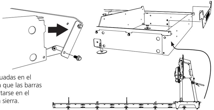
Desmonte la placa final y la pieza final situadas en el extremo del tubo de riel. Tenga en cuenta que las barras de tiro del remolque Trailerkit deben montarse en el extremo del riel siguiendo el sentido de la sierra.
