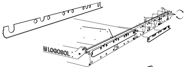
Monte las ruedas del cabezal de la sierra en la placa antivuelco. Utilice las arandelas y las tuercas del conjunto de montaje existente.
