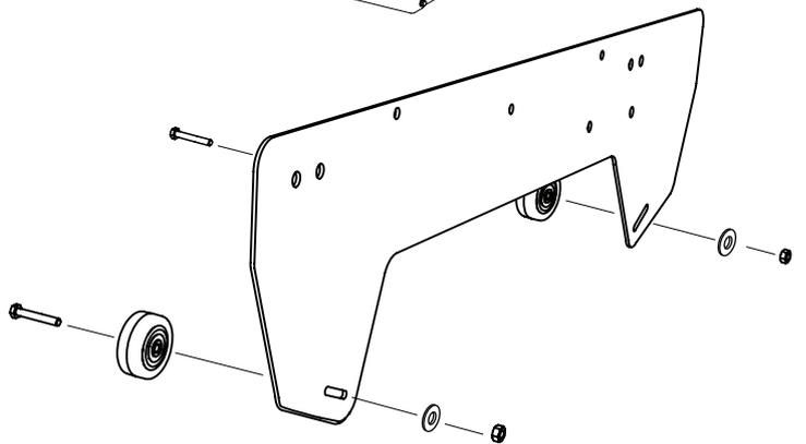
Monte el bloqueo del cabezal de la sierra en el tubo del bogie. Las tuercas existentes deben reemplazarse con el artículo 03-03011. A continuación, vuelva a repetir el montaje en el segundo tubo del bogie.
