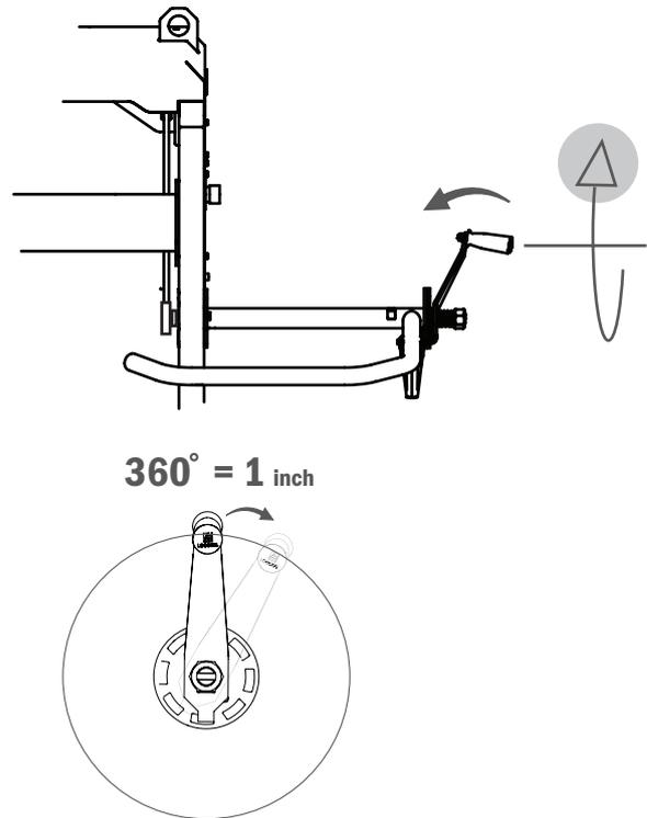
Der Verriegelungsmechanismus der Kurbel ist in acht Schritte pro Umdrehung unterteilt. Bei jedem Schritt wird der Sägekopf um 1/8 Zoll und bei einer vollen Umdrehung um 1 Zoll gesenkt bzw. erhöht. Teilungsscheiben mit 16 Stufen sind als Zubehör erhältlich.
