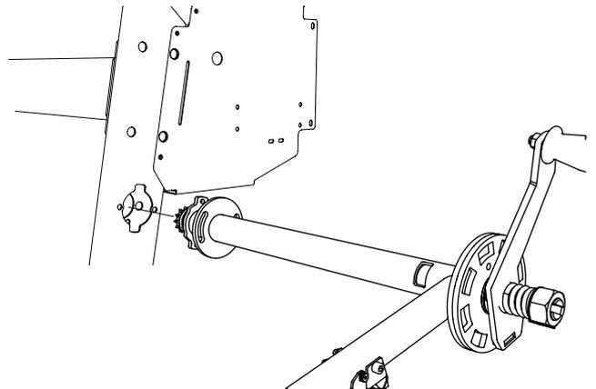
Setzen Sie den Griff in das Pylonrohr ein.
