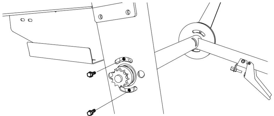
Das Griffrohr mit den langen Schrauben sichern. Beachte, dass die Innenmutter so platziert wird, dass der Kopf der Inbusschraube mit der Oberfläche des Beines bündig ist.
