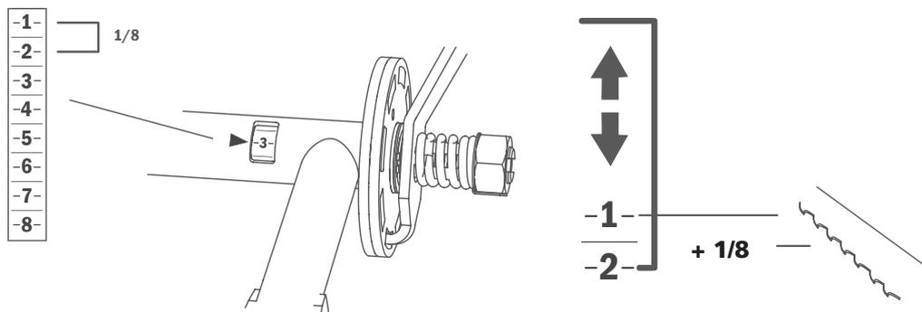
Auf der Kurbelwelle gibt es eine Öffnung, wo Du die Zahlen auf einer Skala sehen kannst. Diese Skala hat acht Schritte, wobei jeder Schritt 1/8 Zoll ist. **TIPP:** Wenn ein Brett oberhalb des Bandes geschnitten wird, musst Du für die Schnittfuge, d.h. 1/8", kompensieren. Das Schnittholz unter dem Band muss nie für die Schnittfuge kompensiert werden. Es hat das gleiche Maß, das auf der absoluten Skala auf dem vorderen Bein des Sägekopfes gezeigt wird.
