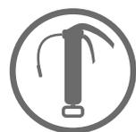
Cuando aparece este símbolo durante el trabajo de montaje, es preciso lubricar las piezas antes de proceder con el montaje. Lubrique las piezas afectadas con grasa universal.
