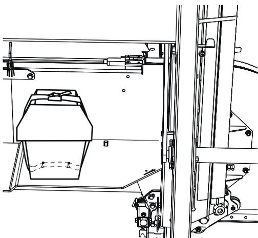
La batería se coloca en la caja de protección y se sujeta con una correa tal y como se muestra en la imagen.
