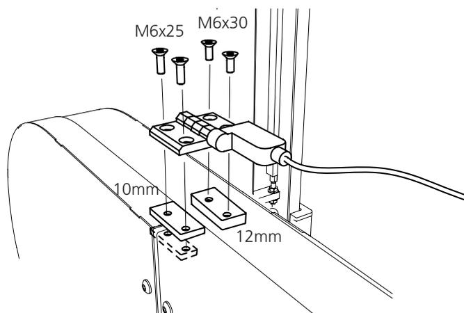
**MONTAJE: INTERRUPTOR DE SEGURIDAD Y ARRANQUE ELÉCTRICO**
