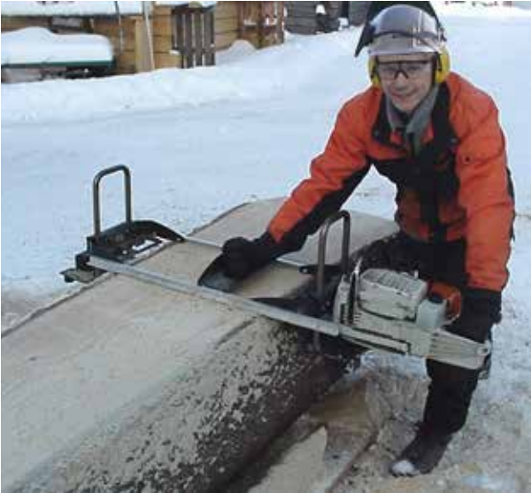
LSG ohne Führungsholm. Die glatte Oberfläche des Baumstamms führt den nächsten Schnitt.
