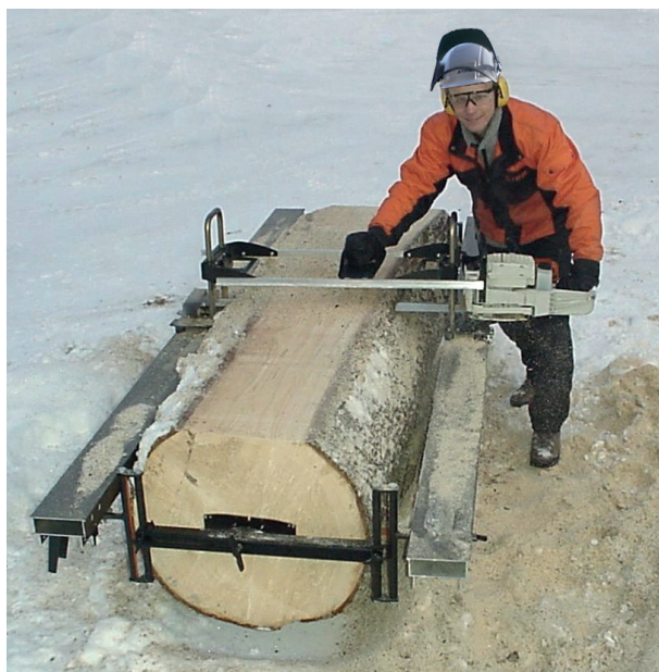
Big Mill PRO: LSG con dos raíles guía, brazo EXT y placa de fijación EXT. Los perfiles de deslizamiento (pos. 4, página 27) no hacen contacto con el tronco.
