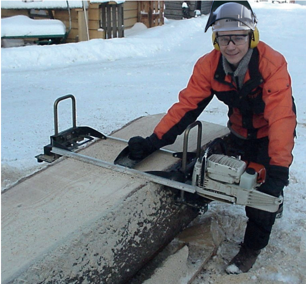
LSG sin los raíles guía. La superficie plana del tronco sirve de guía para el próximo corte.
