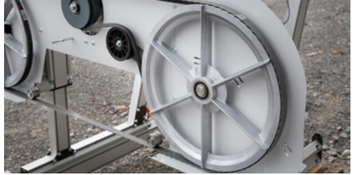
Tuulettimella varustetut vannesahapyörät jäähdyttävät terää ja pitävät suojakannen puhtaana.
