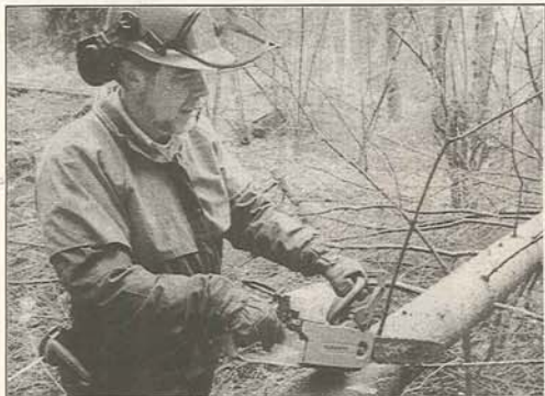
Kvista aldrig över axelhöjd. Låt svärdet vila mot stammen och använd sågen som en hävstång.
