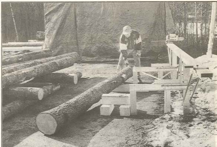
Ett effektivt sätt att få upp enstaka tunga stockar på Solosågen. Lyft stocken i lill-ändan, skjut in ett underlägg. Läg underlägget så långt in under stocken att du kan väga upp stor-ändan.
