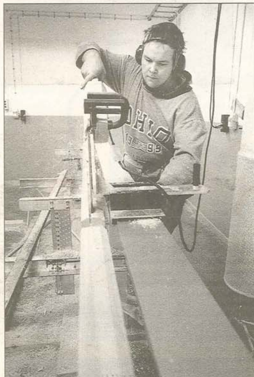
Så här tillverkas draget med hjälp av en motorsåg, monterad i en tillsats till Solosågen.
