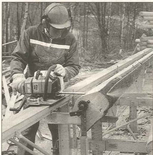
Med timringstillsatsen framställer du stockar för timring i alla former på ett snabbt och enkelt sätt. Med tillsatsen gör du även fjäder och drag.
