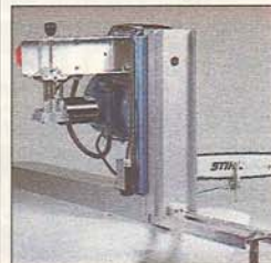
En vikbar linjalbit gör att du snabbt och enkelt får din elsåg i rätt läge för filning av kedjan.
