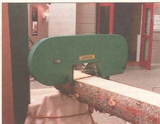
Den nya bandsågen passar direkt på Solosågen och ökar såghastigheten 3-4 gånger. Det här är en prototyp som visades på en mäsia för industridesign våren 1995. Seriemodellen har vissa mindre förändringar.
