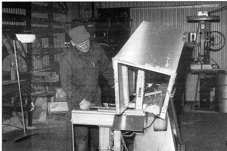
Nisse Söderholm visar ett exemplar från Logosols uppfinnarverkstad. Det är en vedkap som drivs med Logosols elsåg. Du som redan har elsåg får en säker och effektiv kap för måttliga pengar.
