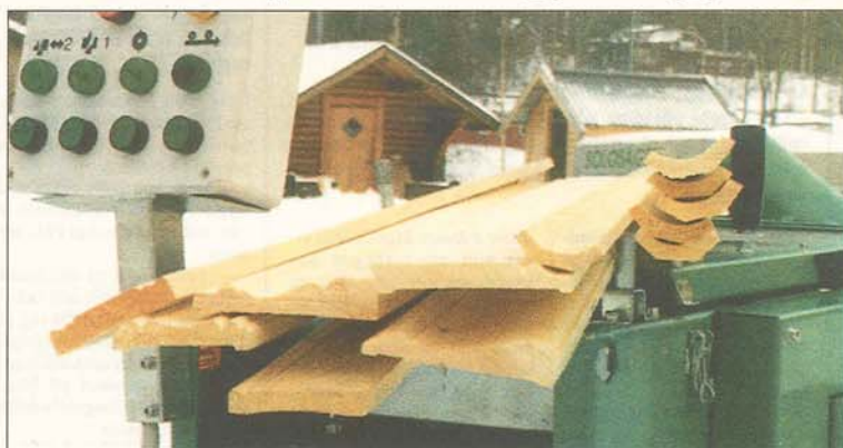
Den nya fyrkuttriga panelhyveln från Logosol får proffsprestanda, 260 mm arbetsbredd och samtidig hyvling på alla fyra sidorna. Här är några exempel på paneler som du själv kommer att kunna göra med den nya hyvelmaskinen.
