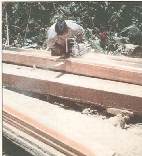
Timmerjiggen visade sig vara ett utmärkt komplement vid sågning av riktigt grova tropiska träslag. Först sönderdelas stocken med Djungelsågen, sedan skivas blocken upp med Timmerjiggen.
