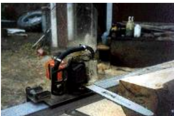
Paul Jonsson i Kramfors har monterat en vindruta på motorsågen som enligt hon sätter stopp för besvärande spånsprut. Rutan är av makrolon och sitter fast med två verktygshållare på handtagsbågen för att lätt kunna tas bort.
