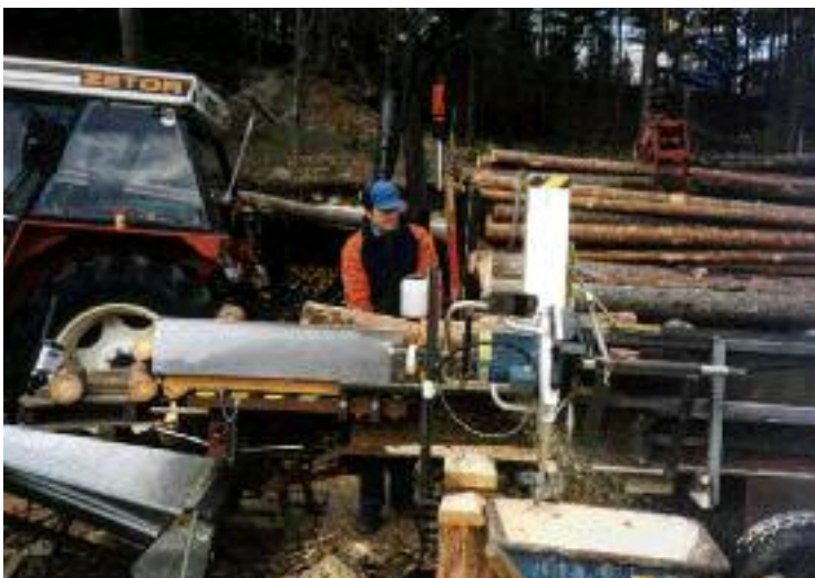
Christer Falk i Valbo har dubbel nytta av sin Logosol E 5000. När den inte gör tjänst på Solosågen använder han sågaggetaget som vedkap. Han har gjort en anordning som utnyttjar traktorns hydraulik för kapning och matning. Hans maskin klyver även veden. Ett snabbt och smidigt sätt att ordna gårdens behov av ved, rapporterar han.
