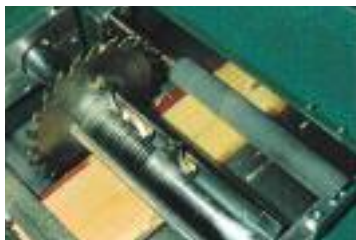
Så här ser Solohyvelns kutter ut. Den har fyra spår för samtidig användning av plan- och profilstål.
